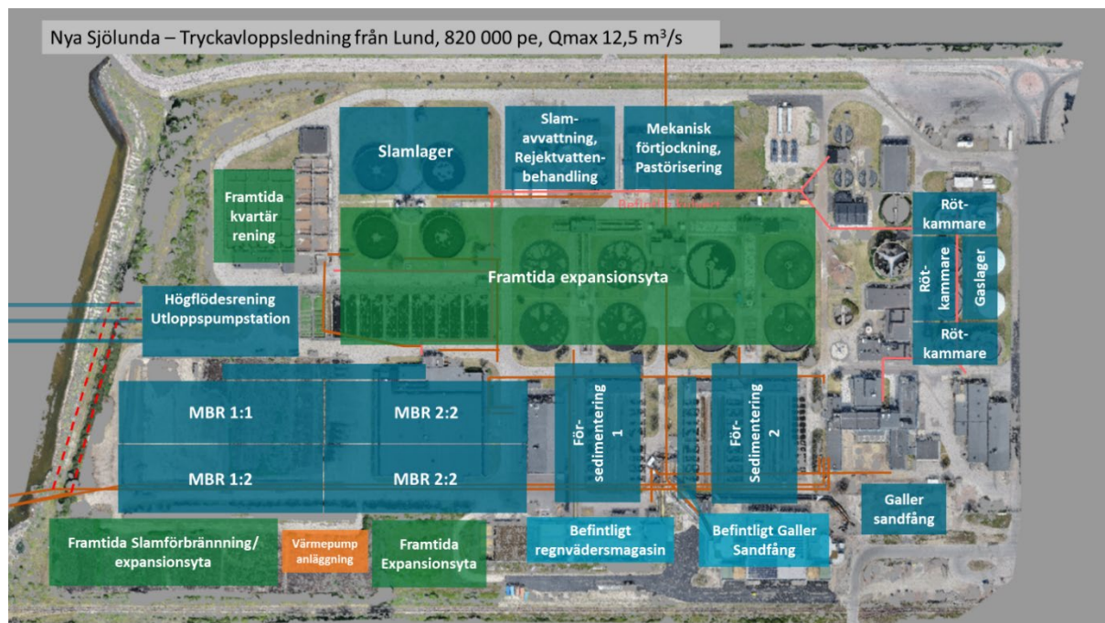
Figur 15. Översiktlig layout Sjölunda ARV – ledningsanslutning norr
