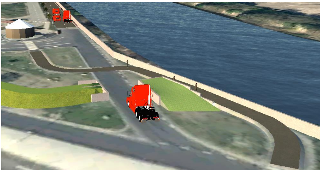
Figur 4 Visualisering av lösningförslag vid infarten till Nordreflintsvägen. Tillfälliga skydd behöver monteras vid infarten och cykelbanan vid högvatten.
