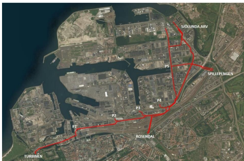
Figur 19. Tryckavloppssystem för pumpning av avloppsvatten från Malmö till Sjölunda ARV.
